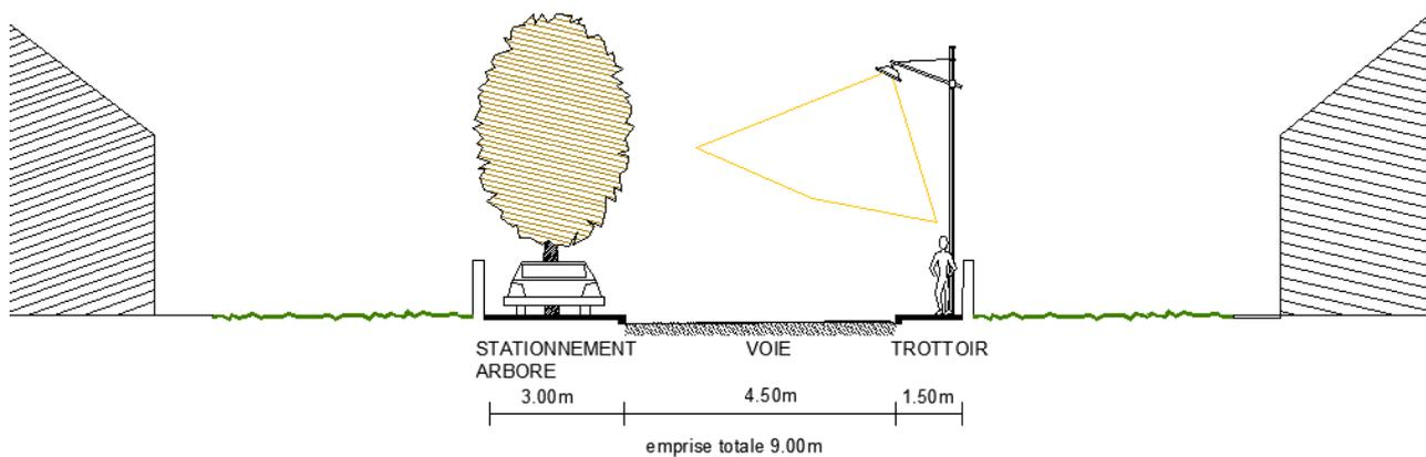
Le principe de voirie ci-dessous s'applique lorsque les eaux pluviales sont tamponnées par une noue paysagère le long de la voie. Les dimensions ne sont pas prescriptives.
